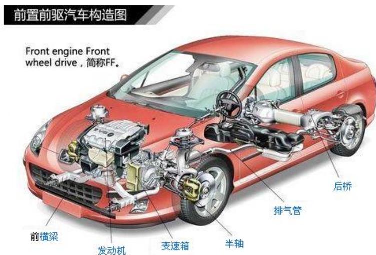
图1 发动机在汽车上的常见布置
