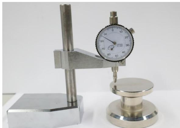
图2-17 端面圆跳动误差检测
