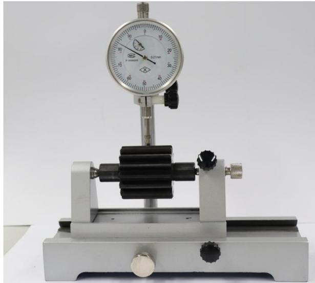
图3-3 齿圈径向跳动检测
