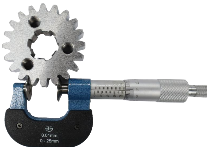
图5-8 用公法线千分尺测量公法线长度
