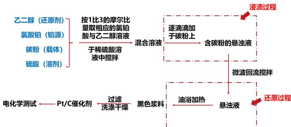
图 1 Pt/C 催化剂合成流程图
