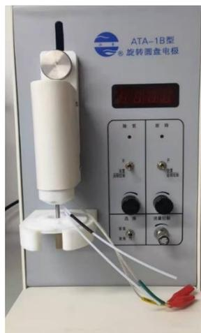
图1 旋转圆盘电极测试装置
