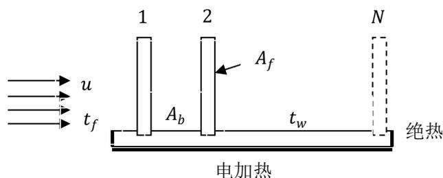
图 2 带有延展体的实验示意图
