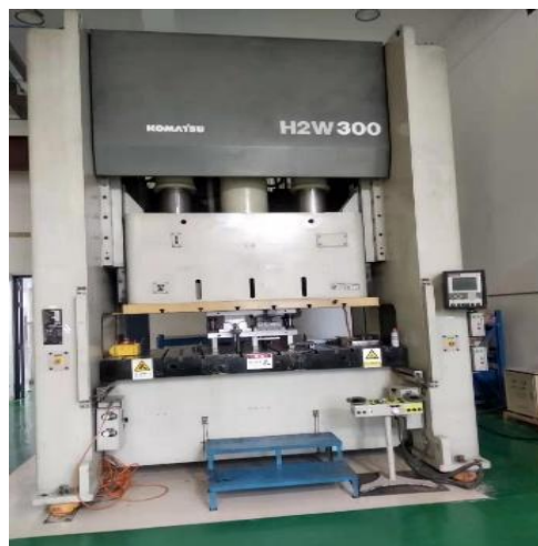
图 2-3 小松压机外形图
